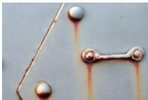
**6.2. Galvanik Korozyon:** Genellikle farklı metal bağlantılarında meydana gelir - bağlantı elemanı delikleri, elektronikler, kablo konnektörleri, vb. Galvanik Korozyon, asındırıcı bir elektrolit içindeki daha asıl bir metal veya metal olmayan bir iletkenle elektriksel temas nedeniyle bir metalin hızlandırılmış korozyonudur.
