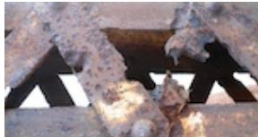
**6.4. Yuzeysel Parcalanma:** Metalin yüzeyinde küçük delikler veya çukurlar oluşturan lokal korozyonu ifade eder. Paslanmaz çelik çukurlasma korozyonuna karşı özellikle hassastır.
