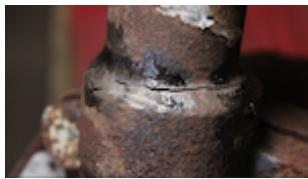
**6.6. Gerilim Korozyon Catlagi (SCC):** Korozyon ve cekme geriliminin birlesik etkisiyle bir malzemenin catlamasi durumudur.
